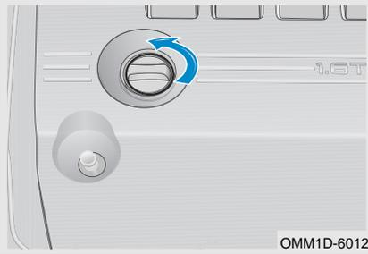
Шаг 1. Отверните пробку маслозаливной горловины двигателя против часовой стрелки.
