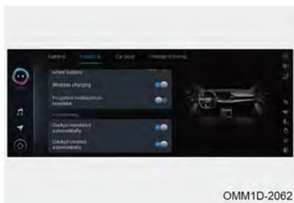
Переведите выключатель пуска двигателя в положение ON. Включите функцию дистанционного включения и отсроченного выключения вентилятора: Audio System (Аудиосистема) – A/C Setting (Настройка системы кондиционирования воздуха).
