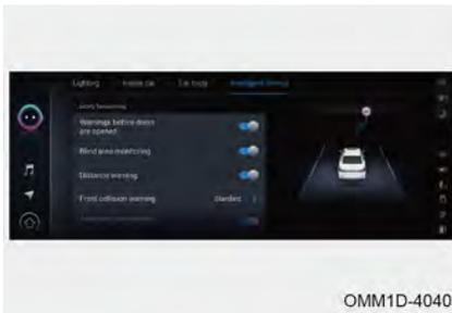
При выключателе пуска двигателя, находящемся в положении ON, включите систему BSD: Audio System (Аудиосистема) – Intelligent Driving (- Интеллектуальные системы помощи водителю) – Blind area monitoring (- Система контроля «мертвых» зон).
