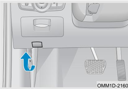
Шаг 1. Потяните за рукоятку отпирания капота. Передняя часть капота при этом слегка приподнимется.
