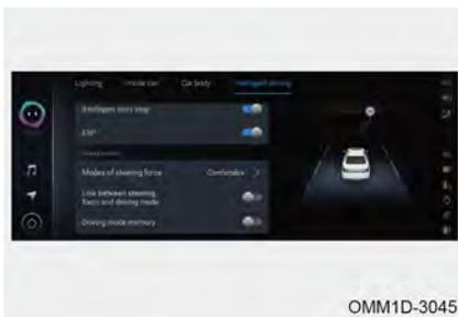
Переведите выключатель пуска двигателя в положение ON. Включите функцию сохранения в памяти выбранного режима вождения: Audio System (Аудиосистема) – Vehicle Setting (Настройка систем автомобиля) – Driving assistance setting (Настройка системы помощи водителю). При следующем включении зажигания будет автоматически выбран тот режим, который был активен на момент последнего выключения зажигания.
