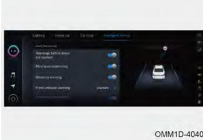
Переведите выключатель пуска двигателя в положение ON и включите систему автоматического экстренного торможения, систему предупреждения о фронтальном столкновении и систему контроля дистанции: Audio System (-Аудиосистема) - Intelligent Driving (-Интеллектуальные системы помощи водителю).
