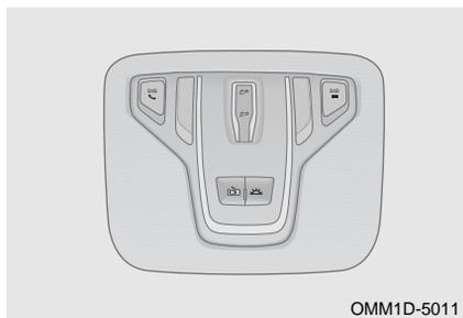
Устройство вызова экстренной помощи предназначено для ручного (-нажатием кнопки «SOS») вызова экстренных оперативных служб, передачи минимального набора данных автомобиля, координат его местонахождения, времени, а так же установления громкой связи пользователей автомобиля с оператором государственной федеральной системы ЭРА-ГЛОНАСС посредством сотовых сетей (GSM).
